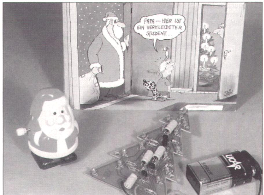
Fahren Sie mit den Eck-LEDs LD9 und LD16 fort, so dass ein „LED-Dreibein“ entsteht und die Platine nicht mehr kippen kann. Sie können jederzeit Spannung anlegen und kontrollieren, ob *jede* Leuchtdiode ein- und aus-
